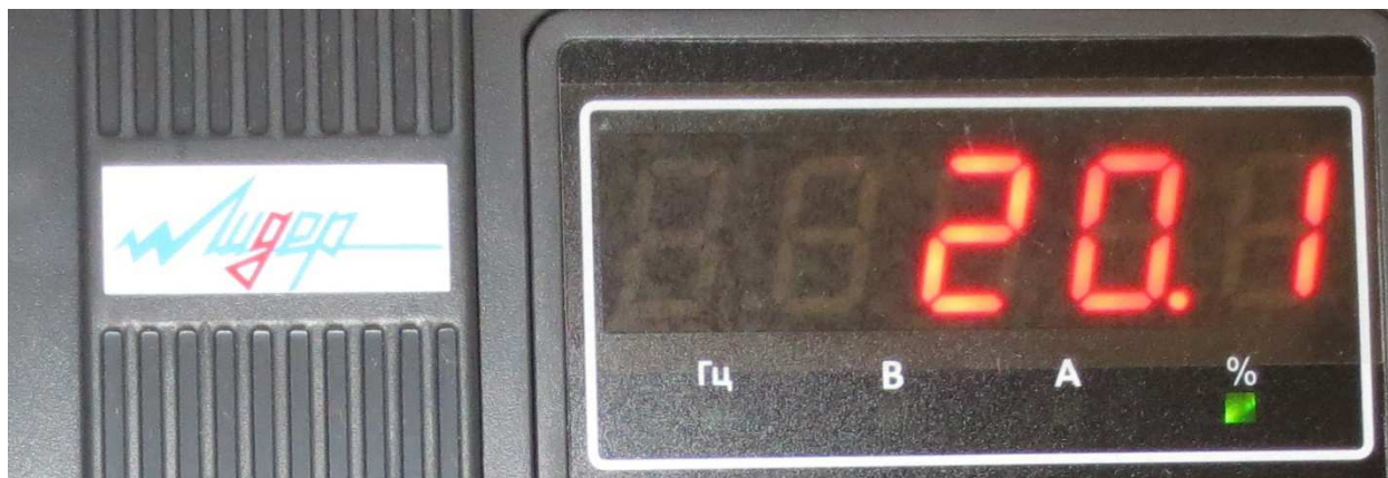
Рис. 5 Параметр обратной связи ПИД
