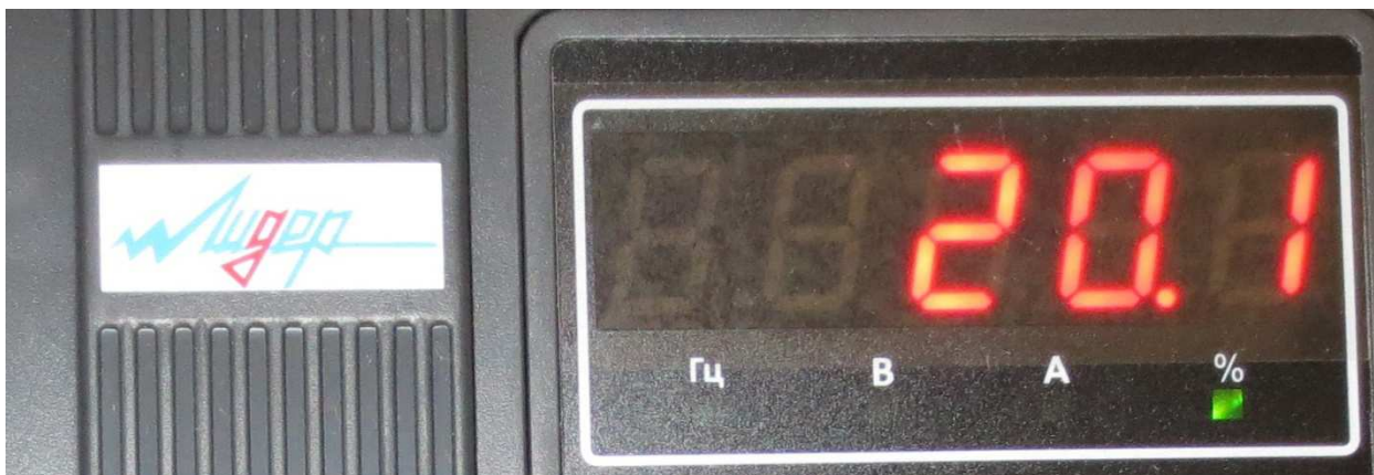
Рис. 6 Параметр обратной связи ПИД
